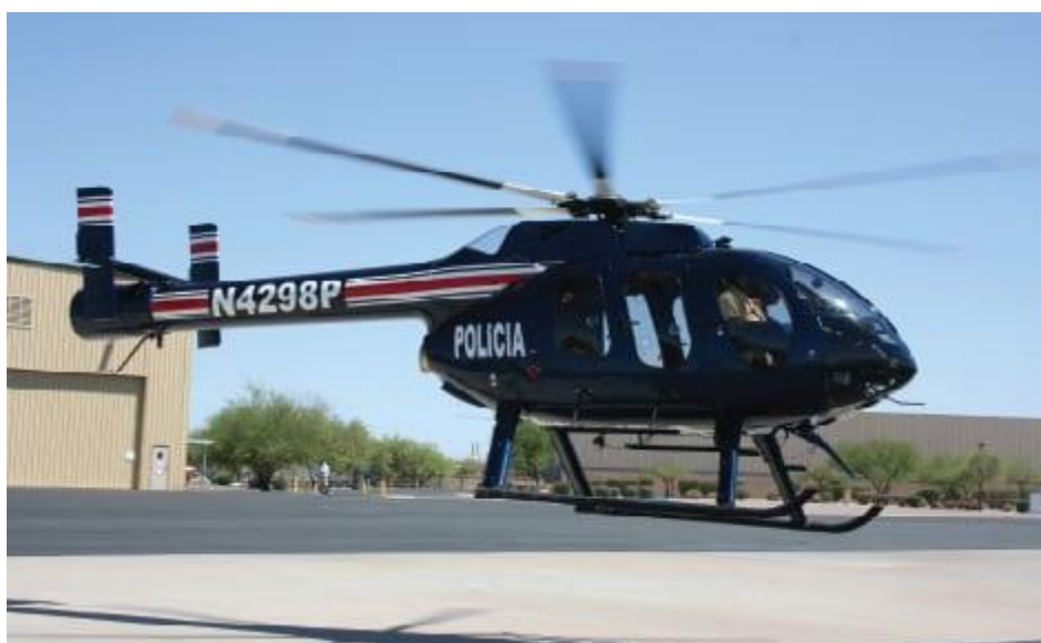
Figura 7 - Helicóptero com tecnologia NOTAR, modelo MD600
